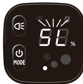
バッテリー残量表示に “SL”が3秒間早点減 (0.2秒間隔)
